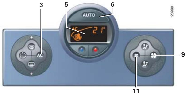
**Nota:** la funzione «visibilità» determina automaticamente l'inserimento dell'aria condizionata (spia accesa). Per ripristinare la modalità automatica, premete il tasto **6**.
