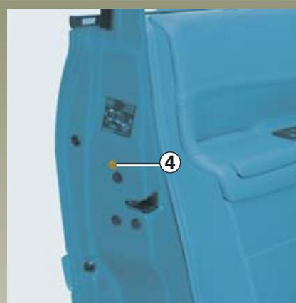
**Blocco manuale della serratura di ogni porta**
